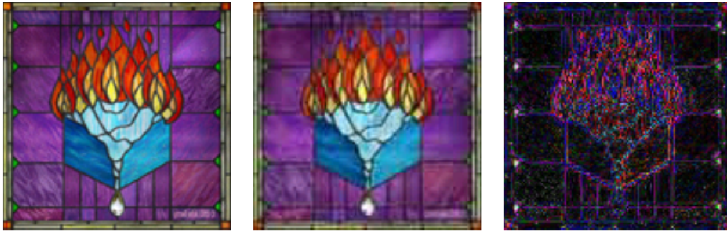
Figura 7.10: Resultado de utilizar una tasa elevada en la compresión JPEG. La imagen comprimida aparece difuminada. La última imagen es la resta de las dos primeras.
