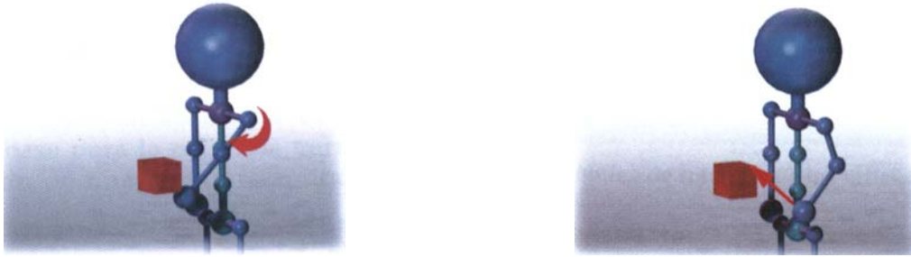
Figura 5.11: A la derecha un ejemplo de cinemática directa. A la izquierda uno de cinemática inversa.
